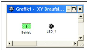
Wenn der Schalter eingeschaltet wird, sollen wiederkehrend zwei kurze LED-Blitze entstehen.
